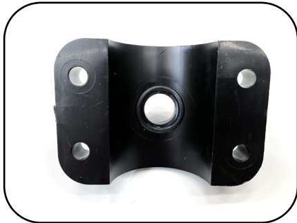
Auf richtigen Sitz der Gummidichtung achten und Ring fetten
