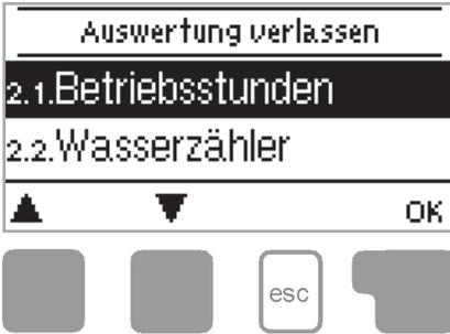
Das Menü "2. Auswertung" dient zur Funktionskontrolle und Langzeitüberwachung der Anlage.
