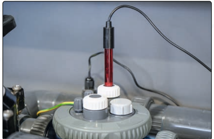
Redox Sonde eingesteckt
