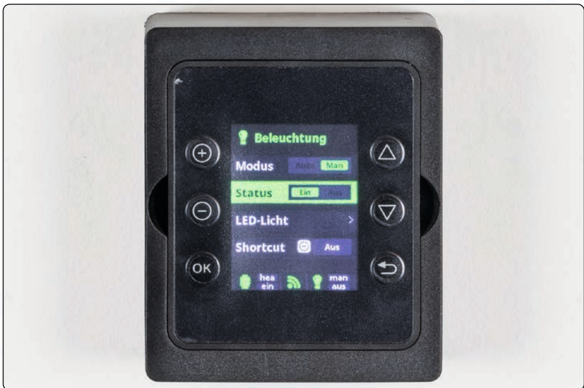
Lampe manuell EIN / AUS schalten
