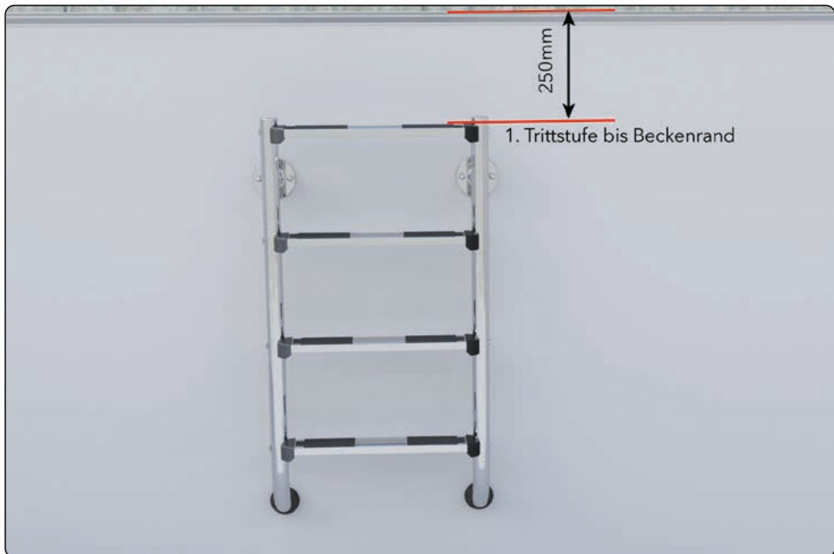
Einbauhöhe Zweiteilige Leiter
