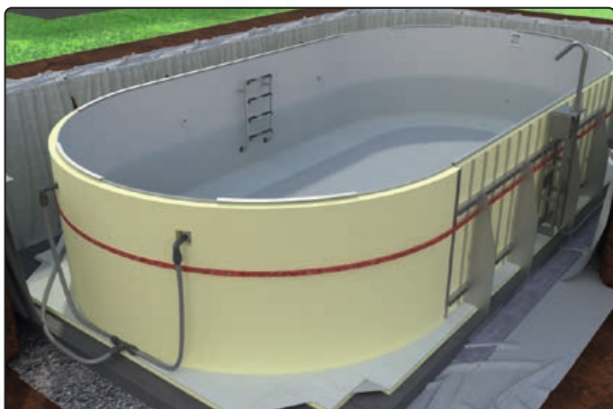
Becken bis auf 60 cm Höhe befüllen
