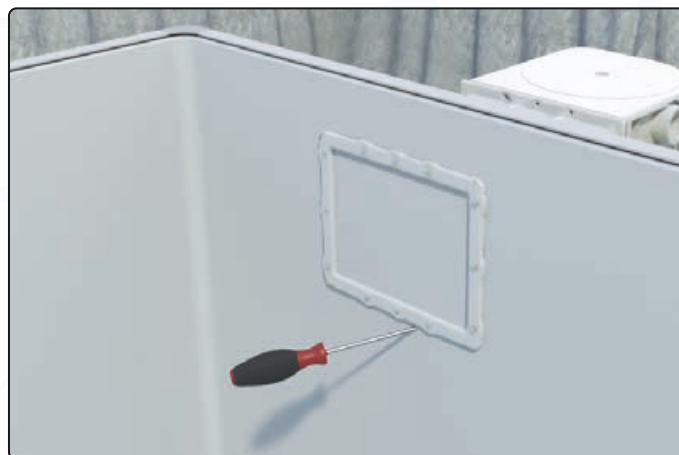
Flansch mit dem Skimmer verschrauben
