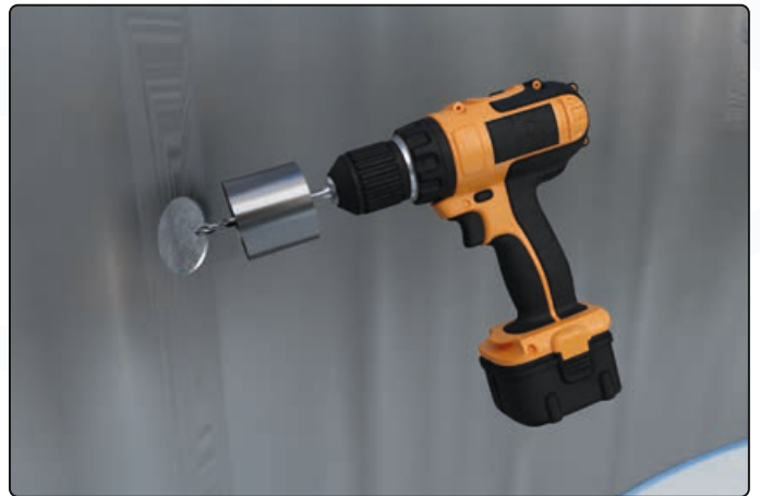
Loch anzeichnen und bohren
