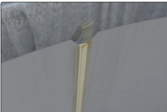
Scharfe Kante mit Klebeband abkleben
