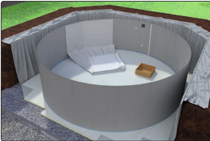
Führen Sie die Folie in den Pool ein
