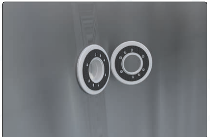
Kleben Sie die Dichtungsscheiben auf
