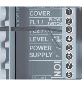
Chlorsondendetektor (rotameter) FL2 ③ schwarz ⑤ braun ⑥ blau
