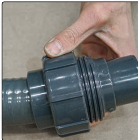
Überwurfmutter ansetzen und verschrauben
