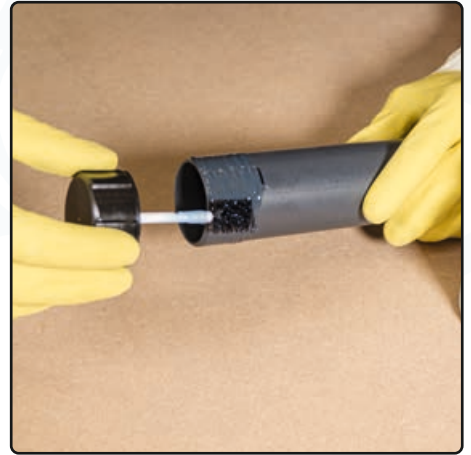
Kleber außen auftragen
