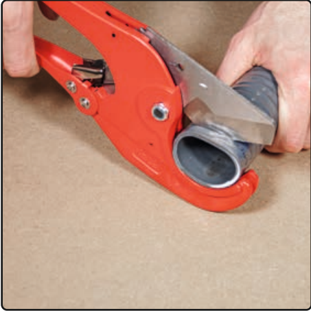
PVC - Flexschlauch gerade schneiden
